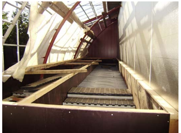
Væksthuset med plantekummerne, hvor den rensede luft fra grisene ledes op gennem filtret af spagnum til tomaterne.
